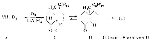
I entsteht aus Vitamin D<sub>3</sub> durch Ozonisierung und reduktive Ozonid-Spaltung. Schonende Chromsäure-Pyridin-Oxydation ergibt II, das bereits von Brockmann beschrieben war; II ließ sich wieder zu I reduzieren. Alkalische und saure Behandlung isomerisieren das trans-Keton II zum cis-Keton (III). Außerdem konnte II unter Erhalt der trans-Struktur in eine Wittig-Reaktion eingesetzt werden, wie aus der Bildung von IV hervorgeht, das sich in I zurückverwandeln ließ.
